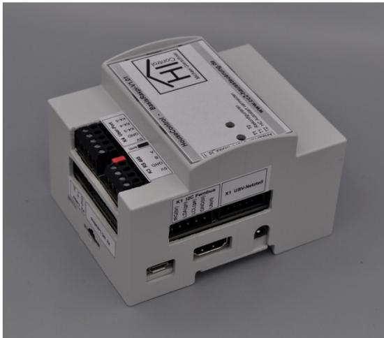
Universell einsetzbares Steuermodul auf Basis des Raspberry Pi 3.
